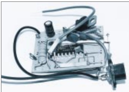
Bild 7: Leiterplatte zum Einbau vorbereitet
