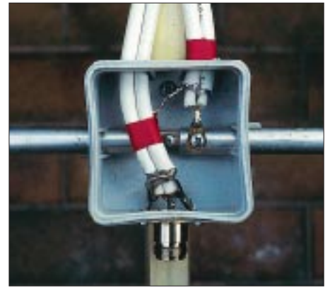
Bild 11: Eigenbauvariante einer Dipolanschlußdose unter Verwendung einer Aufputz-Verteilerdose.
