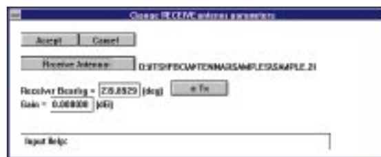
Bild 7: Die Festlegung der Empfangsantenne erfolgt ähnlich wie die der Sendeantenne. Wiederum wurde eine Inverted-L-Antenne ausgewählt („Sample.28“)
