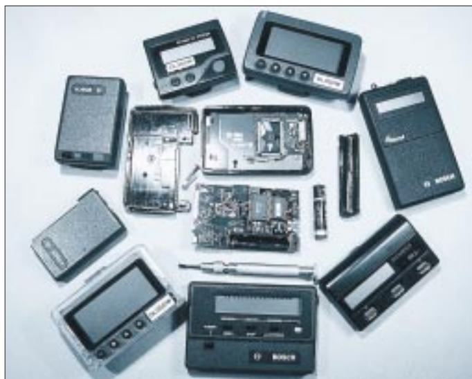
Bild 1: Verschiedene Pager, die auf dem deutschen Markt erhältlich sind. Bei der Zerlegung geht es nicht ohne entsprechendes Werkzeug. Wer bisher noch nicht über einen TORX-Schraubendreher verfügt, sollte unbedingt eine solche Anschaffung tätigen, bevor es zu irreversiblen Beschädigungen an den Schraubenköpfen kommt.
