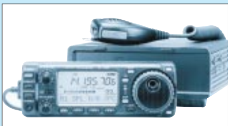
Bild 1: Der von 160 m bis 70 cm reichende Allmode-Transceiver IC-706 als Einsteigergerät? Warum nicht! Es ist völlig legal und ob des günstigen Preis-Leistungs-Verhältnisses keine schlechte Investition in die Zukunft.
