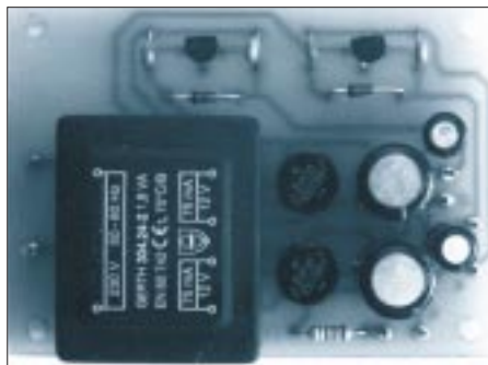
Bild 23: Die bestückte und betriebsbereite Netzteilplatine.
