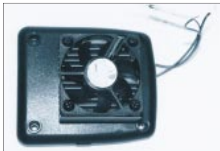
Bild 8: Gehäuseunterteil mit aufgesetztem Pentium-I-CPU-Cooler
