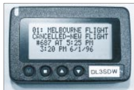
Bild 2: Dieser Skyper NEC21a zeigt eine „zivile“ Anwendung – die Benachrichtigung von Einzelpersonen oder ausgewählten Zielgruppen.
