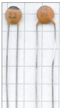
Bild 4: 33 pF in für 2,5 und 5 mm Raster
